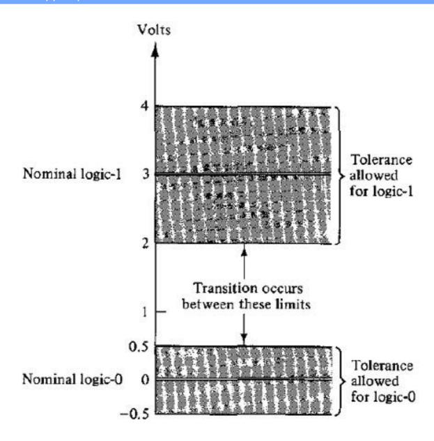
Рисунок 1.1 - Пример представления двоичного сигнала
